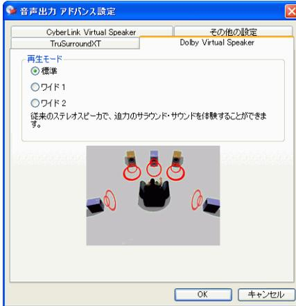
Dolby Virtual Speaker 技術により、2 スピーカでバーチャル・サラウンド音響を実現できます。**標準** モードでは、前方に設置された2つのスピーカの位置から、5 スピーカ音響の環境を、2 スピーカで再現します。**ワイド 1** モードは、前方に設置されている2つのスピーカをより広く空間をもたせるように再現したオプションです。**ワイド 2** モードは、ワイド 1 にさらにサラウンドスピーカを強調させたオプションです。
